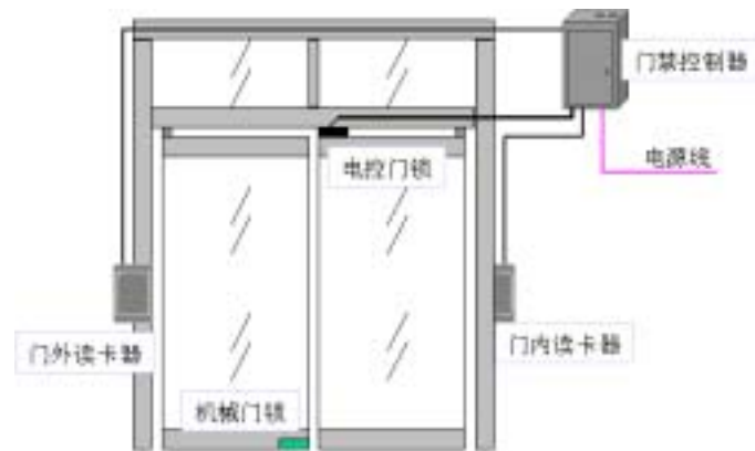
在双开门设计中，一扇用电控锁，另一扇用机械锁是常用的方案
